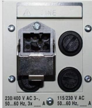
Aus EMV-technischen Gründen ist es erforderlich, dass das Gerätegehäuse zusätzlich mit einer Anschlussleitung von mindestens 4mm<sup>2</sup> (AWG11) mit der Potentialerde des Gesamtsystems verbunden wird.
