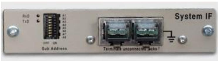
Beim Systeminterface werden die Daten zwischen den Geräten über ein Standard LAN-Kabel übertragen.
