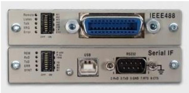
Diese Option beinhaltet die Seriellen Schnittstellen plus die GPIB-Schnittstelle. Die GPIB-Schnittstelle arbeitet nur in Verbindung mit der eingebauten Seriellen-Schnittstelle. Ist im Gerät bereits eine Serielle Schnittstelle (Option ZS01) installiert, muss nur mehr die GPIB Schnittstellenerweiterung (Option ZS03) angeschafft werden. Anschluss und Bedienung entnehmen Sie bitte dem Softwareteil.
