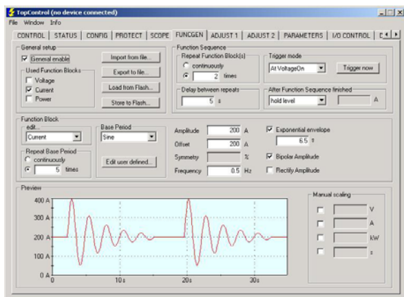
Definition exponentiell abklingender Sinus-Sequenzen in der Bedien- und Service-Software TopControl
