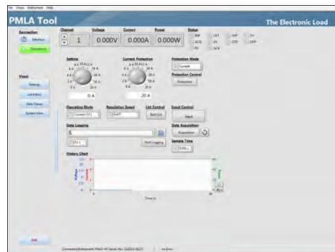
Das PMLA Tool ist eine Steuersoftware für bis zu 72 Kanäle von elektronischen Mehrkanal-Lasten der Serie PMLA. Eine Navigationsleiste wechselt zwischen den einzelnen Anwendungen. Im Hauptmenü (Settings) werden die wichtigsten Geräteeinstellungen vorgenommen und der zu steuernde Kanal selektiert. Eine Messwert- und Statusleiste informiert über den aktuellen Gerätezustand. Die Datenlogger-Funktion kann konfiguriert und aktiviert werden.
