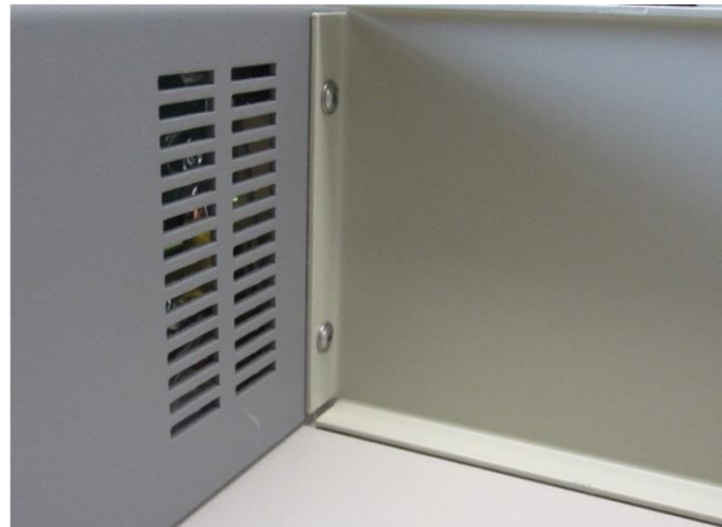
Abbildung 8.4: An Deckel und Gerät fixierter Extender
