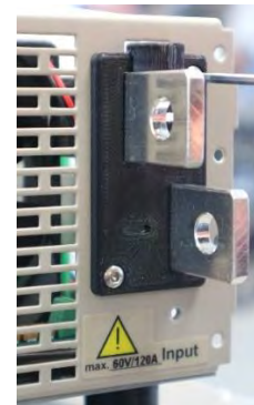
Abbildung 2.13: Neue Schienendurchführung Figure 2.13: New bar feed-through
