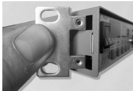
Abbildung 7.7: Anschrauben des linken Anbauwinkels
