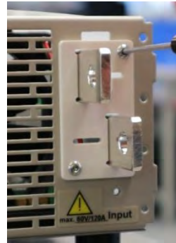
Abbildung 2.12: Zu entfernende Schienendurchführung Figure 2.12: Bar feed-through to be removed
