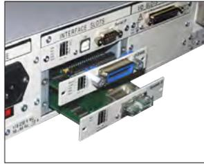
Alle optionalen Schnittstellenkarten sind steckbar und können bei Bedarf ausgetauscht oder erweitert werden.
