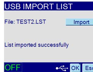
In diesem Fenster kann die ausgewählte Listendatei in das Gerät importiert werden. Dazu wählen Sie mithilfe des grafischen Cursors die Schaltfläche „Import“. Die Listendatei wird nach der Anwahl vom USB-Stick gelesen, interpretiert und in das Gerät übertragen. Danach wird das Ergebnis angezeigt.
