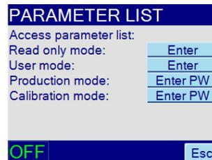
In diesem Fenster kann die Parameterliste ausgelesen und deren frei zugängliche Parameter editiert werden. Des Weiteren kann der Produktions- oder Kalibrierungs-Modus durch Eingabe der entsprechenden Passwörter aktiviert werden.
