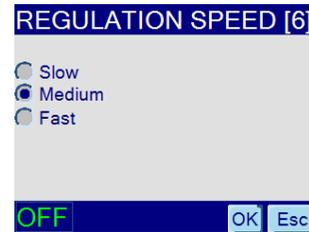
In diesem Dialogfenster kann die Regelgeschwindigkeit für die hardwarebasierte Regelung konfiguriert werden. Es kann dabei nur eine Auswahl getroffen werden.
