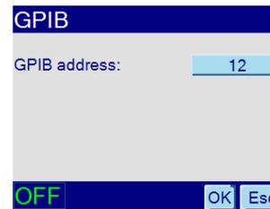
In diesem Dialogfenster können die Parameter der optionalen GPIB-Schnittstelle konfiguriert werden.
