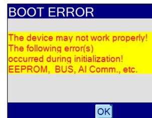
Sollten während der Initialisierungsphase, direkt nach dem Einschalten des Gerätes Fehler auftreten, werden diese im „Boot error“-Fenster angezeigt.
