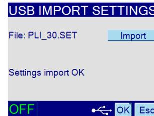
In diesem Fenster kann die ausgewählte Einstellungsdatei in das Gerät importiert werden. Dazu wählen Sie mithilfe des grafischen Cursors die Schaltfläche „Import“. Die Einstellungsdatei wird nach der Auswahl vom USB-Stick gelesen, interpretiert und in das Gerät übertragen. Danach wird das Ergebnis der Operation angezeigt.
