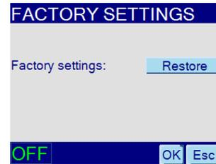
In diesem Dialogfenster kann das Gerät auf seine Werkseinstellungen zurückgesetzt werden.
