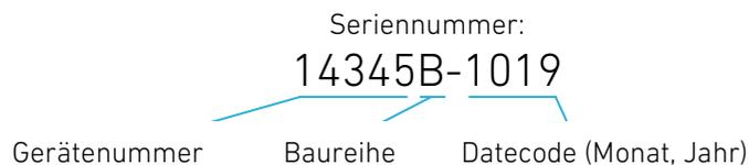
Sie finden die Seriennummer außerdem bei eingeschaltetem Gerät im Menü Technical Data (s. 4.4.92 Technical Data).
